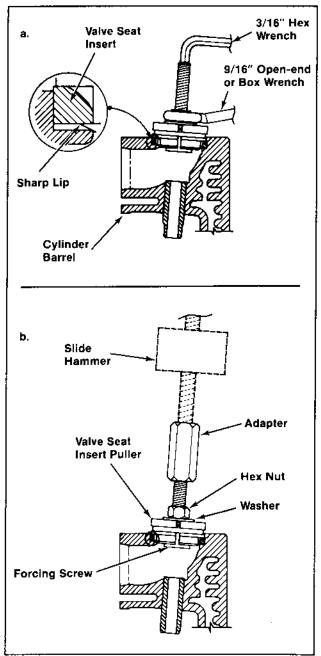
Figure 10-9. Pulling Valve Seat Insert.
