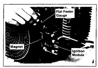
Figure 8-6. Setting Magnet-to-Module Air Gap.
